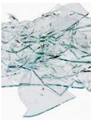
Rottura di un vetro non VSG
