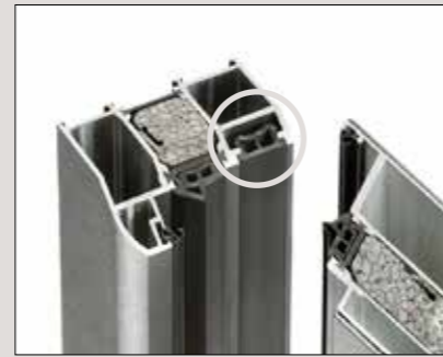
Montagenut für verdeckt liegende Rahmenverschraubung, deckt Schrauben ab, dadurch leichter zu Reinigen
