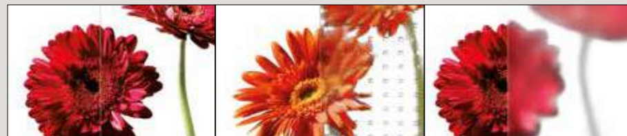
Verglasung: Klarglas (links) / Mastercarré (mitte) / Satinato (rechts)
